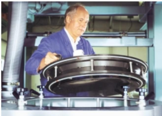
Leichtes Handling beim Wechsel der Düsenkörper. Präzise ausgelegte Düsengeometrien ermöglichen die Rund-Vakuumentwässerung von Schlauchware im Bereich von 7" bis 38" mit nur vier Düsenkörper.
